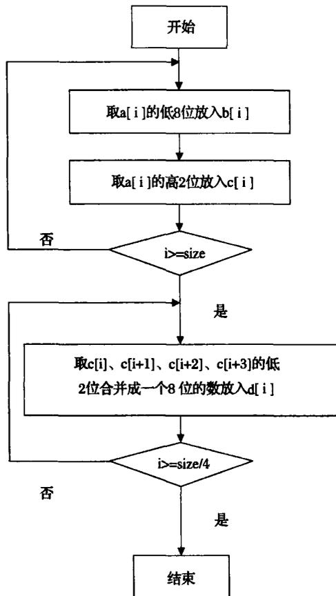
图1 A/D 转换数据存储程序框图
