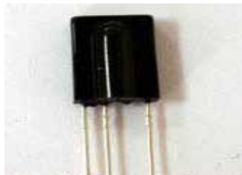
图 3 红外一体化接收头 HS0038 外观图
